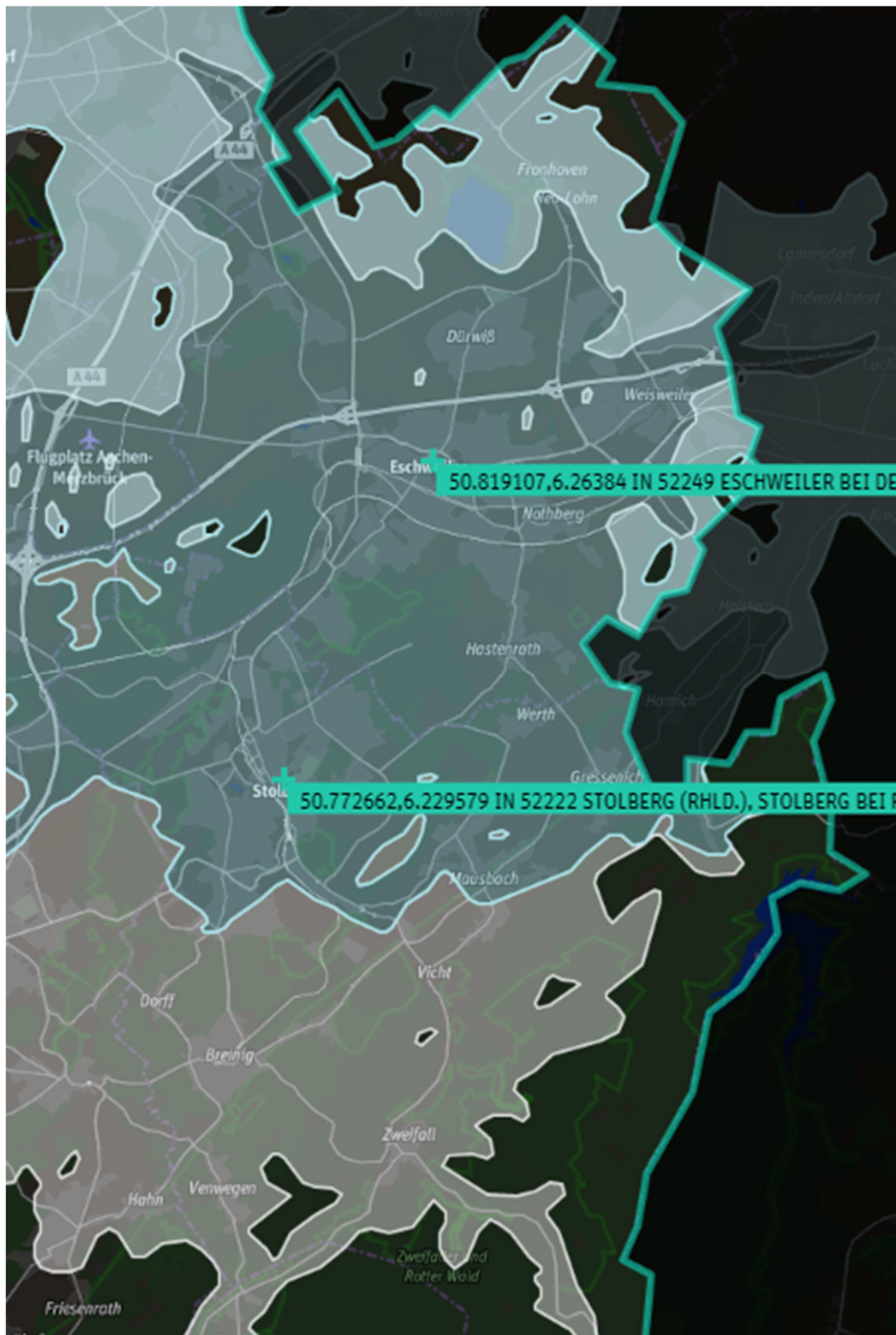
Abbildung 2: Flächendeckung des Versorgungsgebietes Mitte (NA) mit Standortwechsel bei 13 Minuten Anfahrtzeit
